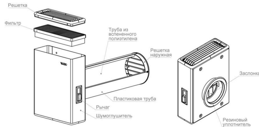
Рис. 1 Общий вид прибора
