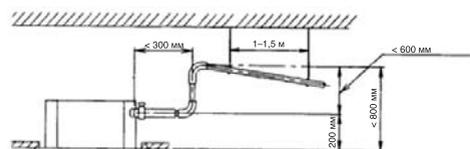
Когда происходит установка дренажного шланга для нескольких агрегатов, необходимо сделать уклон трубок от уровня не менее 100 мм ниже дренажного отверстия каждого агрегата, как показано на рисунке ниже.
