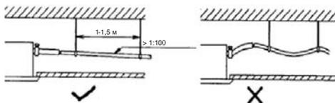
Несмотря на то, что дренажная помпа агрегата способна осуществить подъем на 1200 мм, по возможности располагайте дренажный шланг в соответствии с рисунком ниже.
