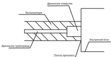
Теплоизоляция должна быть выполнена в виде термоизолирующей резиновой или пластиковой трубки толщиной более 8 мм.
