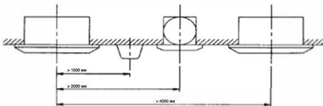
Выбор места установки: основание должно представлять собой деревянную балку, усиленную бетонной конструкцией, являющуюся прочной и надежной и способную выдержать четырехкратный вес агрегата и выдерживать вибрацию в течение длительного времени.
