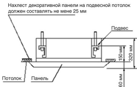
Если агрегат устанавливается в косой потолок, необходимо расположить упругую прокладку между потолком и декоративной панелью так, чтобы агрегат был установлен горизонтально.
