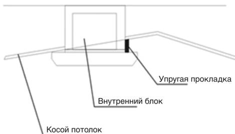
Отрегулируйте положение скобы и монтажной шпильки, чтобы основной блок располагался горизонтально. После установки проверьте уров-
