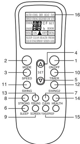
1. Кнопка ON/OFF – включение/выключение.
